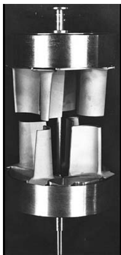
Рис. 5. Многоместная оснастка для нанесения профилированных по толщине покрытий на рабочих лопатках турбин
