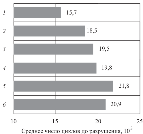
Рис. 5. Влияние технологии обработки образцов из сплава ВТ6ч на их долговечность:
