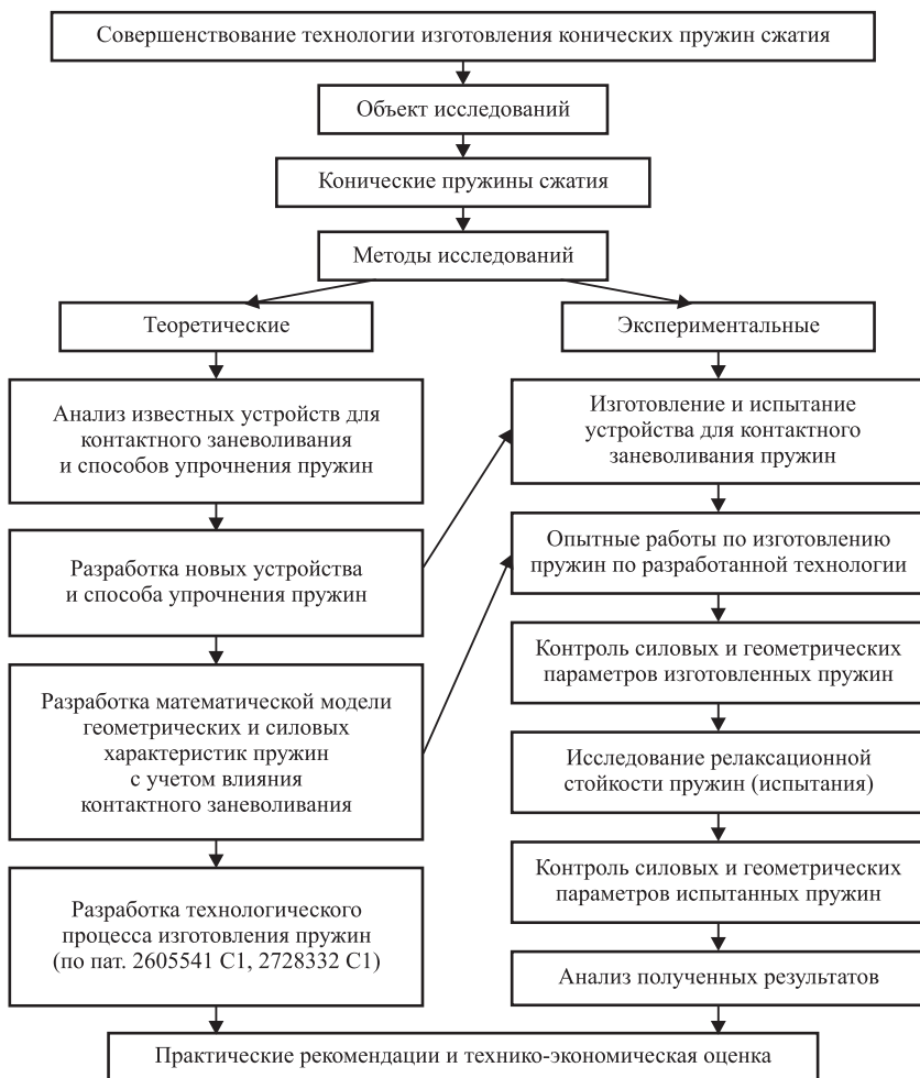
Рис. 7. Блок-схема общей методики экспериментальных исследований упрочнения конических пружин сжатия
