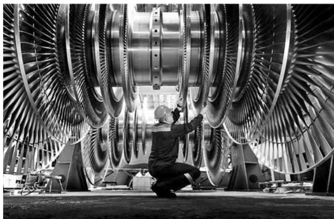
Рис. 1. Ротор с установленными лопатками последней ступени из титанового сплава
