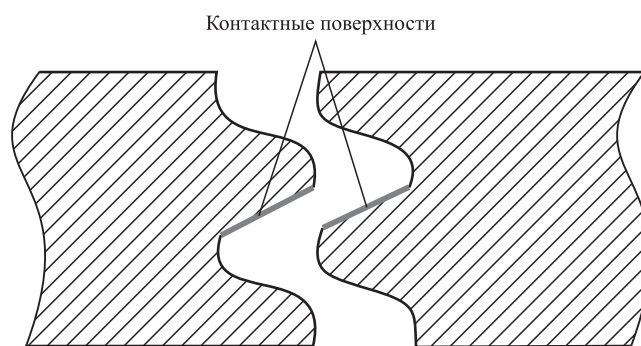
Рис. 2. Пример бандажного зацепления рабочих лопаток
