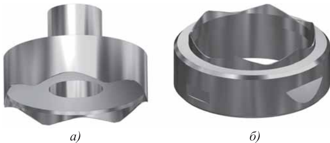
Рис. 6. Твердотельная модель фигурного пуансона (а) и фигурной матрицы (б) для пробивки
