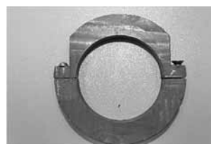
Рис. 9. Медное теплосъемное кольцо (внутренний диаметр соответствует диаметру штуцера, толщина кольца 15 мм)
