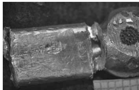
Рис. 8. Один из сваренных образцов-имитаторов (с удаленной зоной термического влияния) после сплющивания
