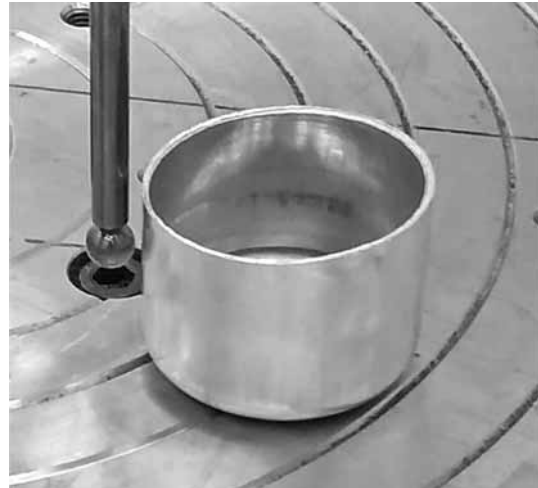
Рис. 2. Процесс измерения толщины стенки заготовки после вытяжки с утонением
