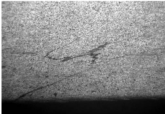
Рис. 5. Оксидные включения в корневой части соединения сплава 1151Т при односторонней СТП. \times 50
