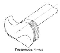
Рис. 1. Изношенные поверхности разжимного кулака
