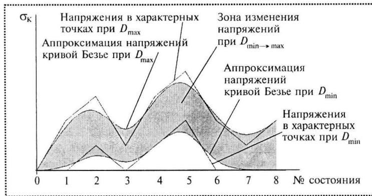
**Рис. 6. Изменения поля напряжений контактирующих поверхностей:**  $D_{\max}$ ,  $D_{\min}$  – соответственно максимальный и минимальный диаметры шарика подшипника;  $D_{\min} \rightarrow \max$  – варьирование диаметра шарика подшипника от минимального до максимального
