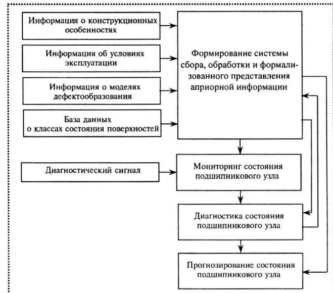
Рис. 1. Основные этапы прогнозирования состояния подшипникового узла
