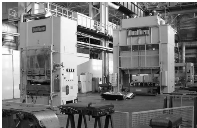
Рис. 1. Участок оборудования Dualform-9 и Dualform-7 для вытяжки панелей сложной формы
