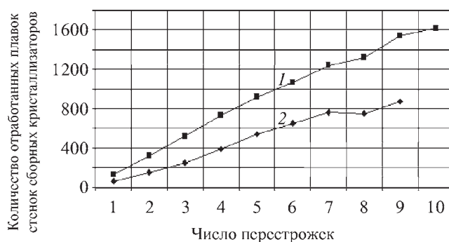
Рис. 4. Суммарное число средних наработок стенок сборных кристаллизаторов от начала до конца их эксплуатации: 1 — материал стенок медь М-ЭЛП; 2 — медь М1р
